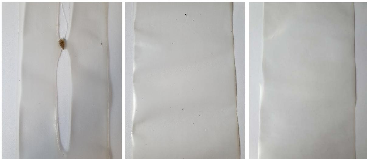
Direkte Verwendung von Regranuliertem Rezyklat ist äußerst kritisch, da sie zu Rissen und Unvollkommenheiten in der Folie führt (Folie 1). Die Homogenisierung vor der Folienextrusion kann die Risse verhindern, aber die Unvollkommenheiten bleiben im Material (Folie 2). Die Zugabe geeigneter Additive verhindert Rissbildung und reduziert die Anzahl und Größe der Unvollkommenheiten in der neuen Folie erheblich (Folie 3), v.l.n.r. Fotos: Fraunhofer LBF.
