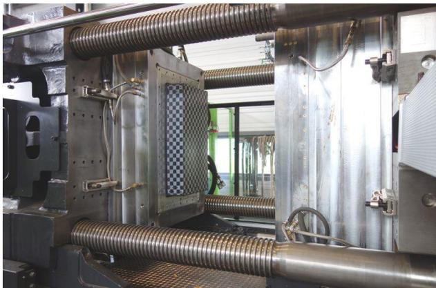
Fertigung des Leichtbau-Batteriegehäuses: Preforms werden in das eigens hierzu entwickelte Spritzgusswerkzeug eingelegt und der Schaumkern injiziert. Innerhalb von nur zwei Minuten ist das Faserverbund-Gehäuse fertig - und das ohne Nachbearbeitung. Foto: Fraunhofer LBF
