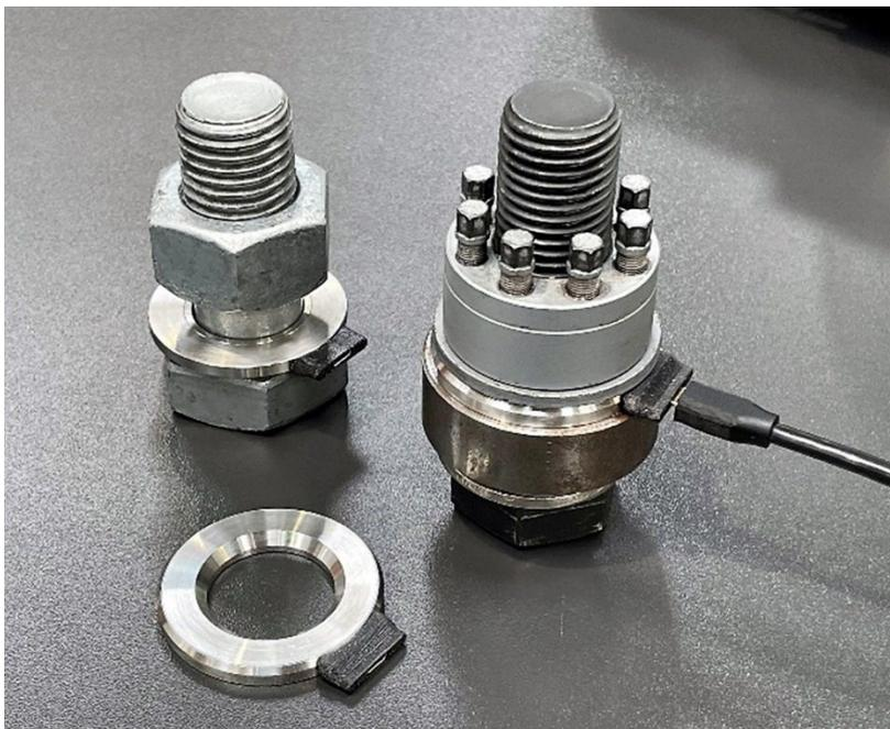
Die dritte Prototypengeneration der kraftmessenden Unterlegscheibe von Altosens.
