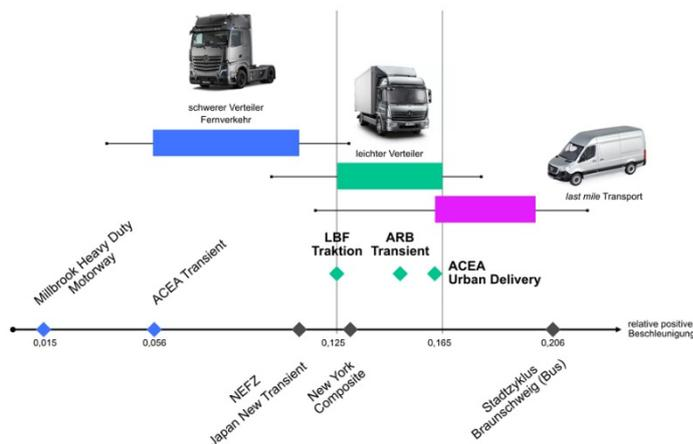
Relative positive Beschleunigung als ein Maßstab zur Bewertung von Lkw-Fahrprofilen.
