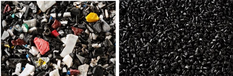
Gemische Kunststoffabfälle (links) und reine, hochwertige Rezyklate (rechts) für neue Kunststoffanwendungen, die dem Kreislauf später erneut zugeführt werden können.
