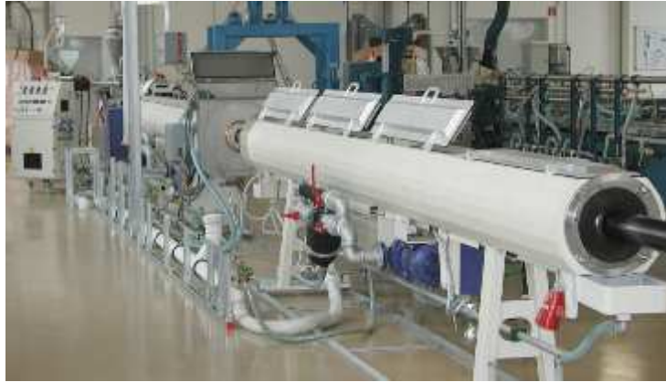
Abbildung 3.27: Zur Rohrextrusion eingesetzte Extrusionslinie
