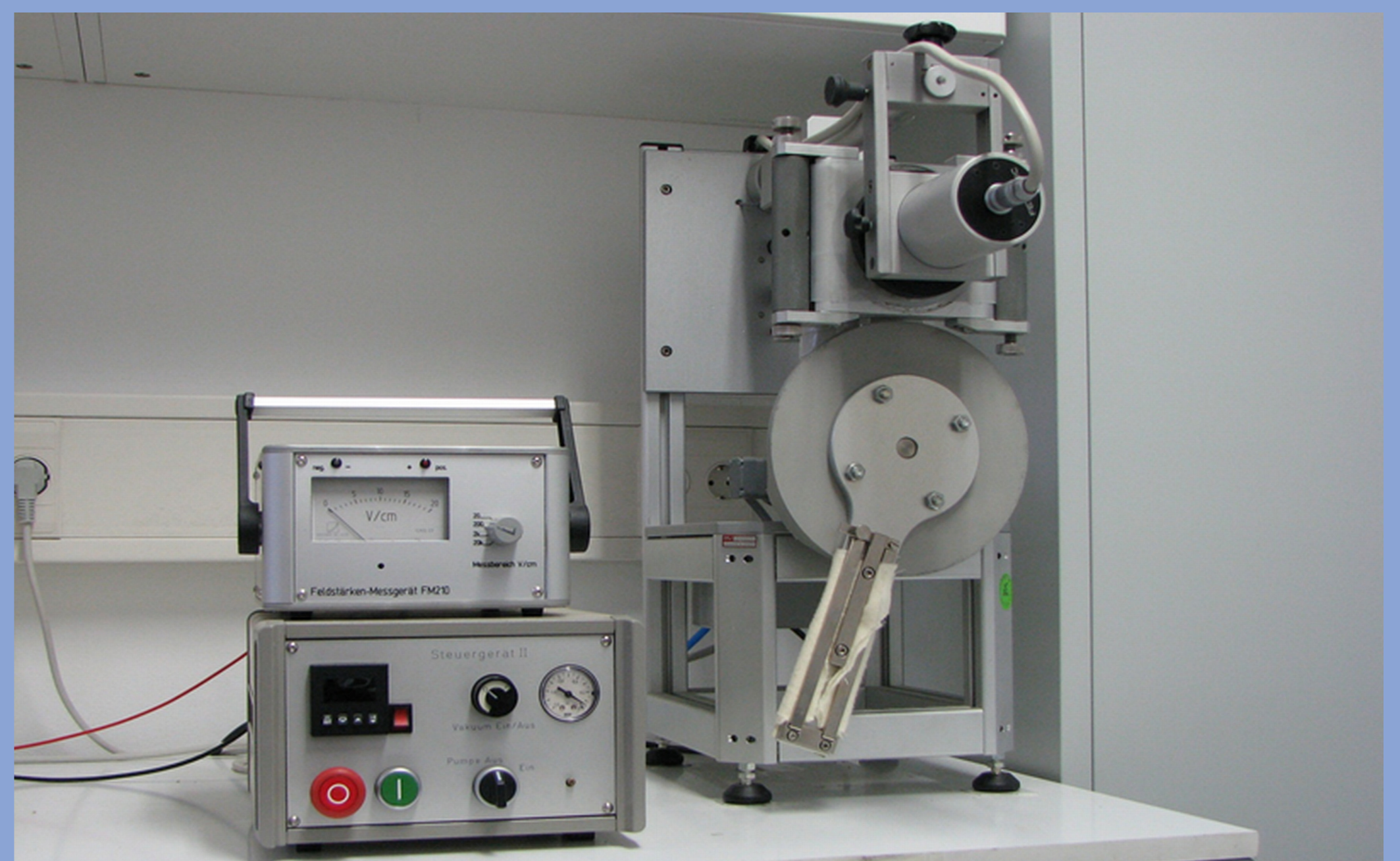
Messung der Aufladung nach DIN 53 486
